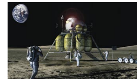
Die verhältnismässig grosse Unterstufe musste ausser der Landung schon die Einbremsung in den Mondorbit besorgen.
