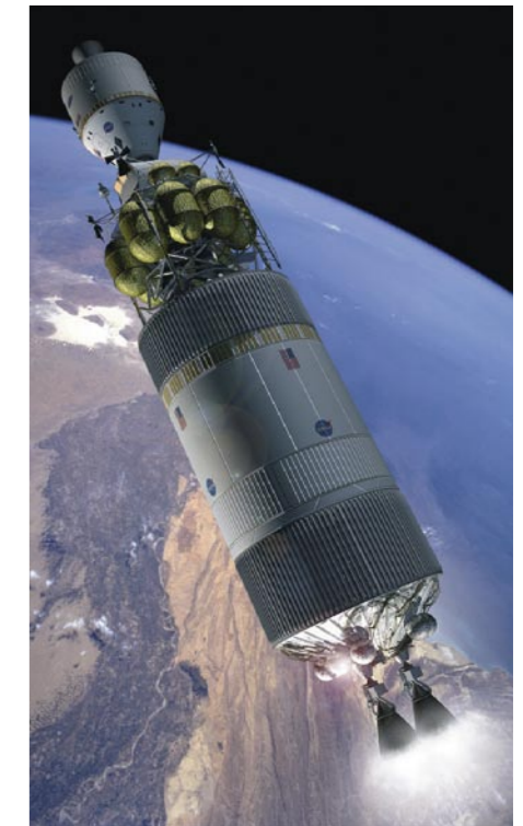
Die zweite Zündung der Oberstufe befördert die gekoppelten Raumschiffe aus der Parkbahn Richtung Mond.
